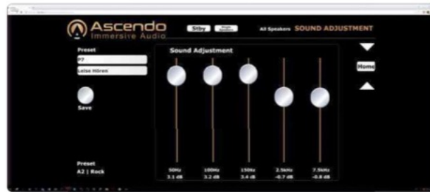
Alle Presets können nach Belieben benannt werden: Hier im Beispiel „Leise hören“ mit angehobenen Bässen und etwas betontem Präsenzbereich
